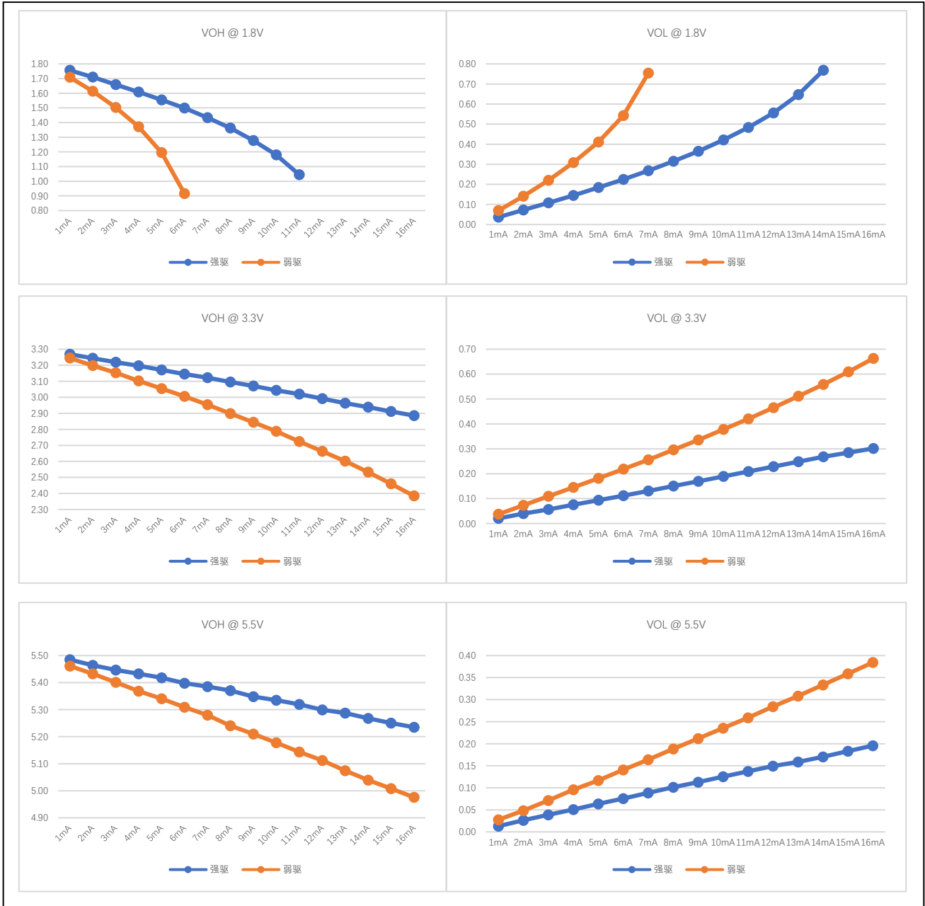
图 7-2 输出端口 VOH/VOL 实测曲线
