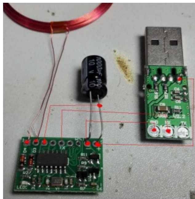
接线说明，模块 1 和 2 焊接天线， 8 是电源负极，9 是电源正极，8 和 9 之间并联一个 1000µF 电解电容（注意电容有极性） 模块 3 焊接模块 9，选择 ASCII 输出模式。 模块 5 脚是 TX 输出接 PL2303 小板的 RX 模块 8 脚接 PL2303 小板 GND，9 脚接 PL2303 小板的 USB 5V 电源脚
